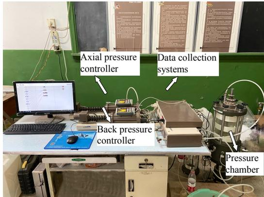
Fig. 1 GDS triaxial apparatus
