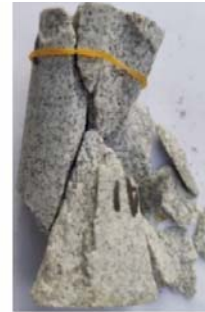
(d) Failure mode of granite [26]
